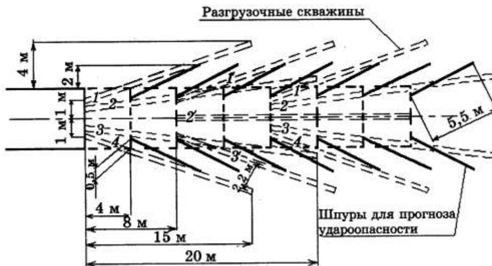
Рис. 9.7. Схема заложения разгрузочных скважин и шпуров для прогноза удароопасности: 1, 2, 3, 4 — разгрузочные скважины первого цикла; 1', 2', 3' — разгрузочные скважины второго цикла
