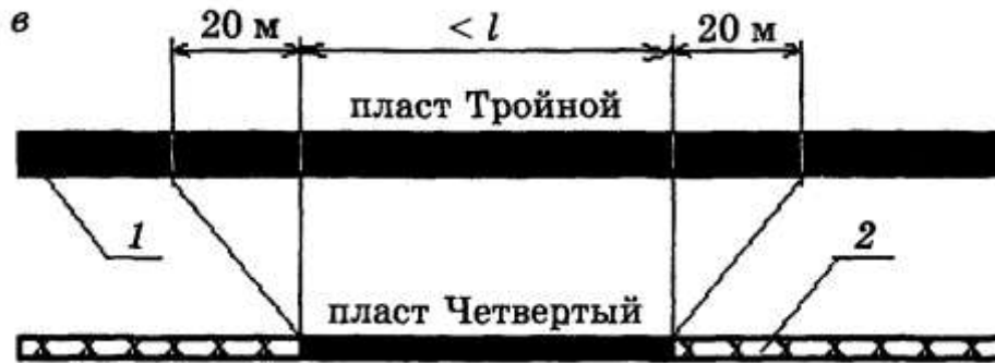
Рис. 9.6. Схема применения профилактических мероприятий в зонах ПГД: а — при проходке выработок в зонах ПГД от створа очистного забоя; б — то же, в зоне ПГД от целика шириной большей l , но меньшей 2l ; в — то же, в зоне ПГД от целика шириной меньшей l ; 1 — угольный пласт; 2 — выработанное пространство
